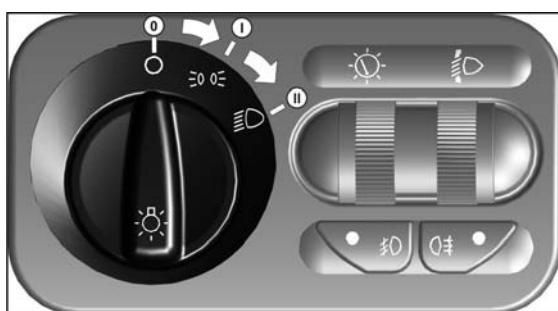
освещение комбинации приборов, заднего номерного знака и некоторых органов управления электрооборудованием;
