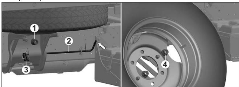
Перед заменой запасного колеса предварительно снимите боковое ограждение с правой стороны автомобиля, отвернув четыре гайки его крепления к платформе.
