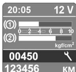
2. При каждом включении зажигания, если значение оставшегося пробега до ТО меньше или равно 500 км.
