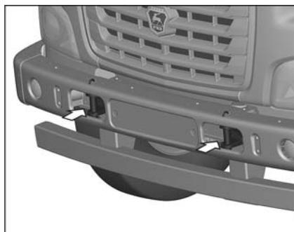
Переднее буксирное устройство (типа шкворень-вилка) состоит из двух шкворней, вставленных в отверстие буксирных вилок. Шкворень стопорится с помощью пружинного фиксатора.
