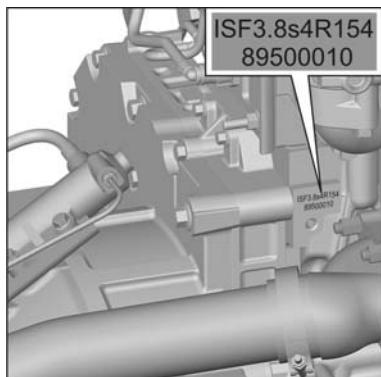
**Идентификационный номер двигателя Cummins** выбит на блоке цилиндров с правой стороны в задней части двигателя рядом с картером задних распределительных шестерен.
