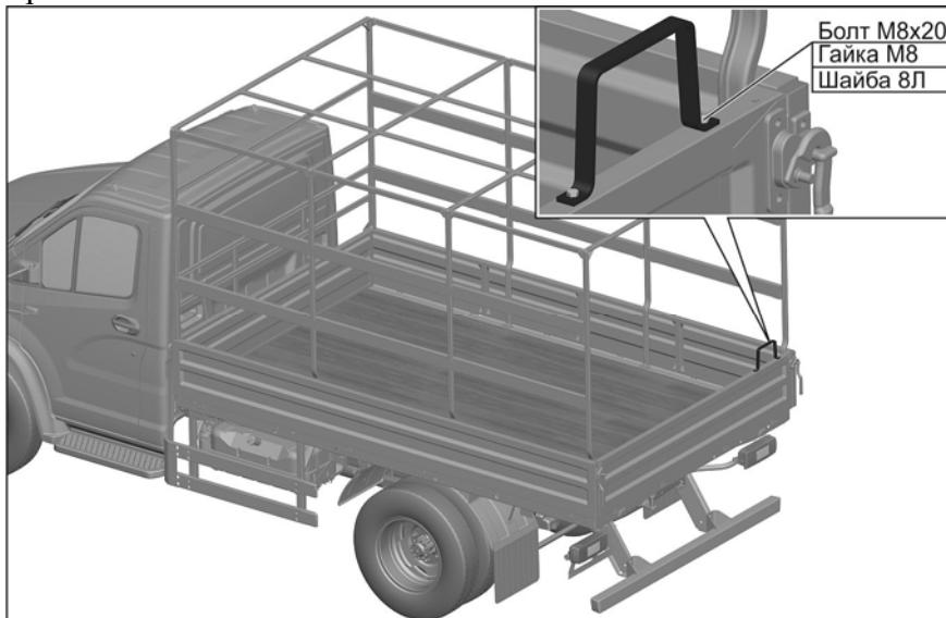
Установите подножку на задний борт платформы, закрепив ее болтами.
