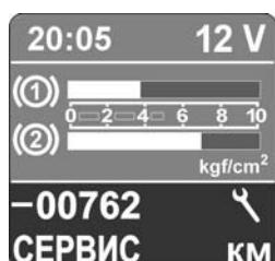
3. При каждом включении зажигания с дублированием звуковым сигналом и надписью «СЕРВИС», если значение оставшегося пробега до ТО меньше или равно 0 км (если значение меньше 0 км, то перед ним ставится знак «минус»).
