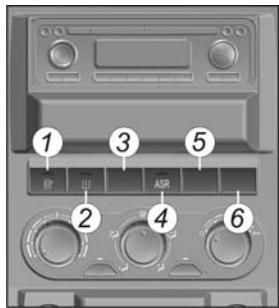
Выключатели имеют контрольные сигнализаторы включенного состояния.
