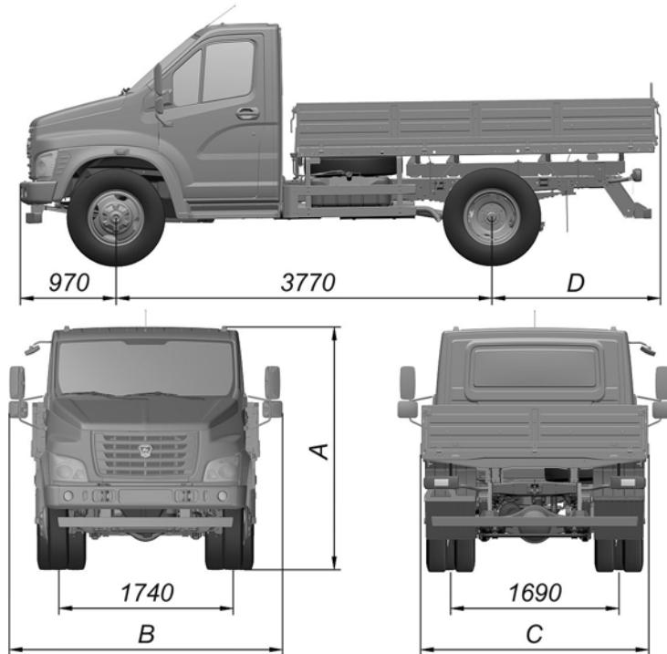
A=2400 мм (для автомобиля с шинами 8,25 R20);
