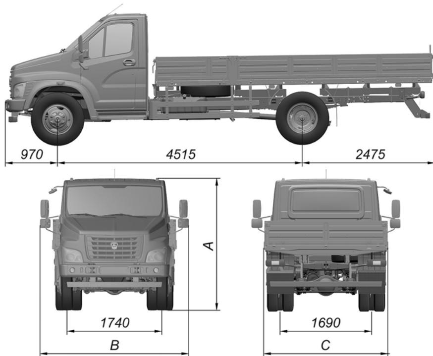
A=2400 мм (для автомобиля с шинами 8,25 R20);
