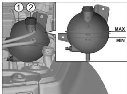
Проверку уровня охлаждающей жидкости в расширительном бачке 1 производите только на холодном двигателе.
