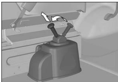
Для затормаживания автомобиля стояночным тормозом потяните рукоятку тормозного крана назад до фиксированного положения. При стоянке на уклоне рекомендуется также дополнительно включить первую передачу коробки переключения
