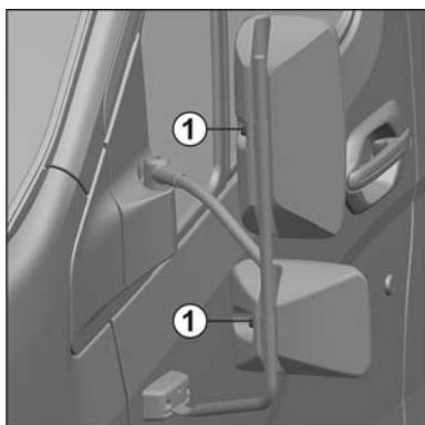
Для регулировки корпуса зеркал (основного и широкоугольного) относительно стойки ослабьте болты 1, отрегулируйте зеркала и затяните болты моментом 11,8-17,6 Н·м (1,2-1,8 кгс·м).
