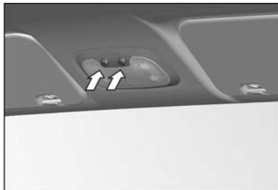
Плафон внутреннего освещения кабины расположен на обивке крыши в передней части. Плафон имеет две кнопки и общую секцию освещения кабины.
