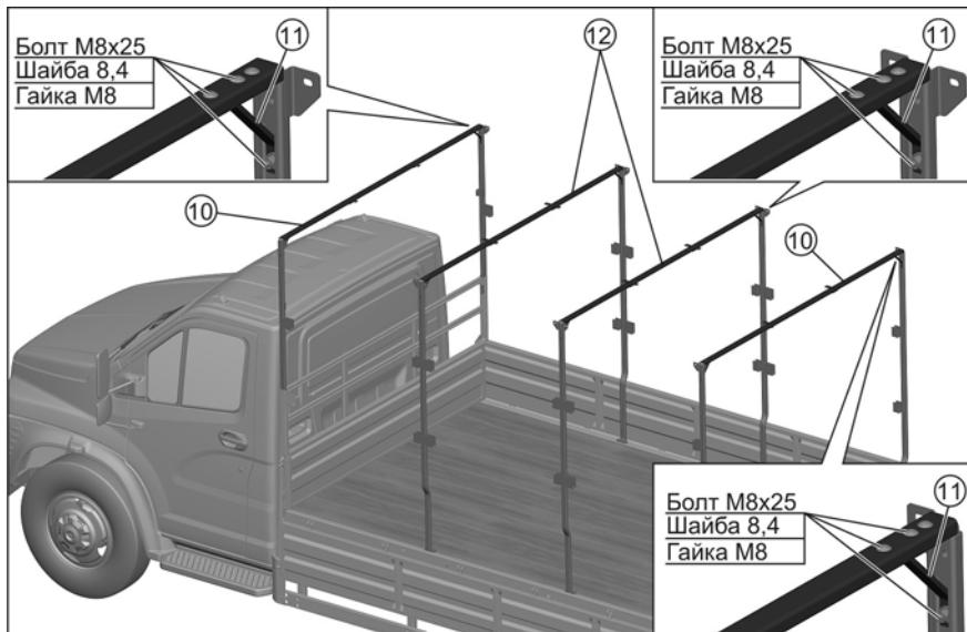
Соедините дугу тента переднюю 10 со стойками тента передними с помощью болтов, а затем через раскосы 11, закрепив их болтами.
