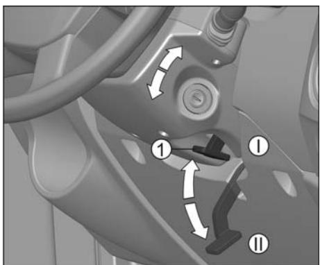
Рулевая колонка регулируется по углу наклона.
