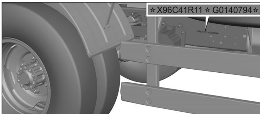
Пример нанесения VIN автомобиля и автомобильного шасси:
