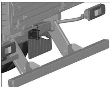
Заднее буксирное устройство аналогично по устройству переднему и состоит из одной буксирной вилки со шкворнем, зафиксированным в нижней части шпилькой.
