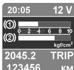
Режим показаний давления воздуха в переднем и заднем контуре тормозов, kgf/cm<sup>2</sup> (атм.) (от 0.0 до 10.0)
