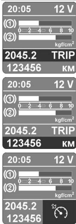
Режим показаний счетчика суточного пробега, км (от 0.0 до 9999.9)
