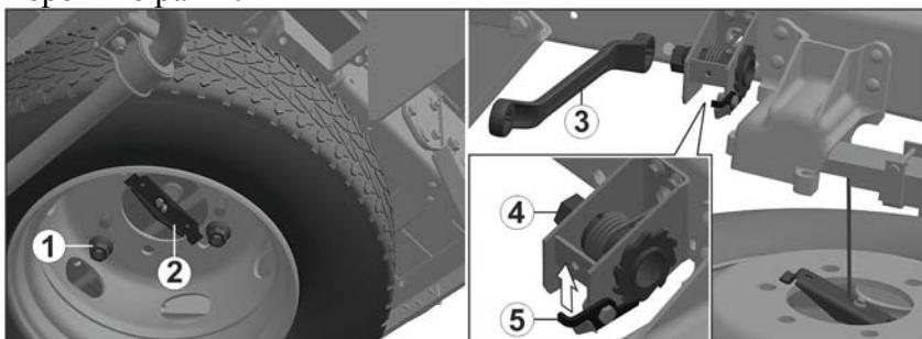
Для снятия запасного колеса отверните две гайки 1 крепления колеса к поперечине. Колесо останется висеть на планке 2, соединенной с тросом подъемного устройства, расположенного на правом лонжероне рамы рядом с кронштейном задней рессоры.
