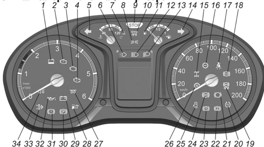
**1. Сигнализатор (оранжевый) низкого уровня охлаждающей жидкости.**
