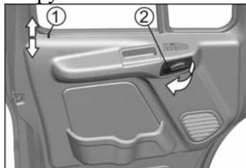
Для открывания заблокированной двери изнутри, потяните два раза ручку 2 на себя: первый раз – для разблокирования замка (кнопка 1 поднимется), второй – для открывания двери.
