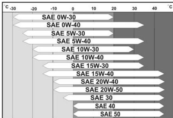
материалы» и классу вязкости по SAE согласно диапазона устойчивых температур окружающего воздуха региона (см. таблицу), в котором преимущественно эксплуатируется автомобиль.
