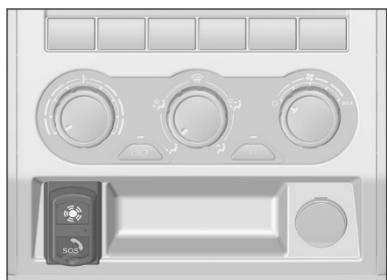
В ОВЭОС входит кнопка экстренного вызова «SOS», совмещенная с микрофоном и кнопка дополнительных функций, расположенные на панели приборов, блок управления и антенна ГЛОНАСС/GPS, размещенные под панелью
