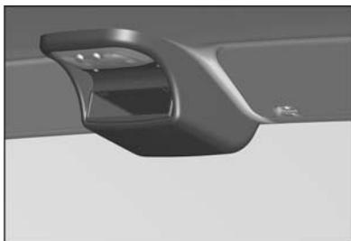
В потолочную консоль имеется возможность установить тахограф или радиооборудование 1 DIN.
