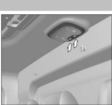
На автомобилях с двухрядной кабиной плафон внутреннего освещения второго ряда сидений расположен на обивке крыши в средней части. Плафон имеет две кнопки и две секции освещения второго ряда сидений.
