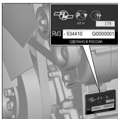
**Идентификационный номер двигателя ЯМЗ** выбит на заводской табличке двигателя, расположенной на блоке цилиндров с левой стороны в передней части под генератором.
