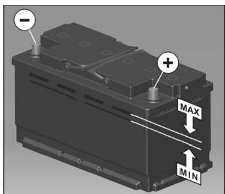
В нормальных условиях эксплуатации батарея почти не требует ухода. Однако, при высокой температуре наружного воздуха, рекомендуется регулярно проверять уровень электролита. Во всех секциях он всегда должен находиться между метками MAX и MIN, имеющимися на корпусе
