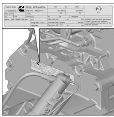
Идентификационный номер двигателя также продублирован на заводской табличке двигателя, расположенной на заднем торце картера маховика.
