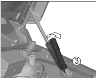
Поверните стопор упора капота 3 в направлении стрелки и удерживайте его в этом положении в начальный момент опускания капота.
