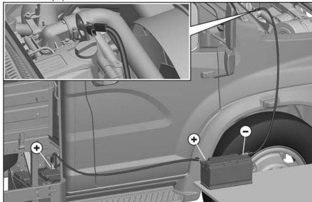
Если аккумуляторные батареи Вашего автомобиля разряжены, двигатель можно пустить от батареи другого автомобиля. При этом, батареи должны иметь
