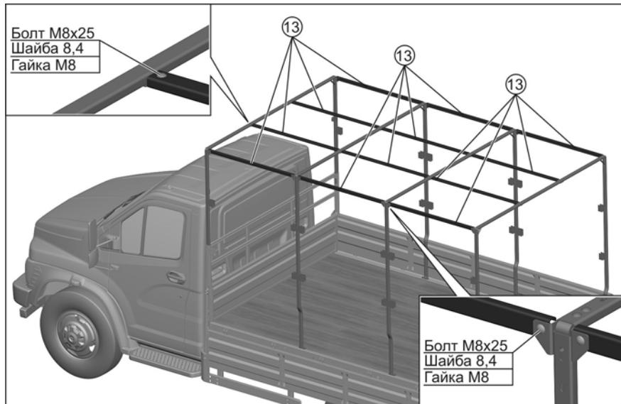
Соедините рейки дуг тента 13 со стойками тента, закрепив их болтами.
