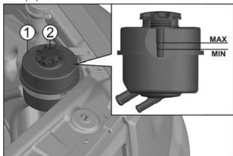
Уровень масла в бачке 1 должен быть между метками, обозначающими допустимый максимальный и минимальный уровень масла, нанесёнными на щупе крышки 2 бачка. Проверку уровня масла в бачке производите на холодном
