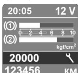
В течение индикации (5 секунд) значения по п.1. кратковременно нажмите кнопку установки на нуль показаний суточного пробега.
