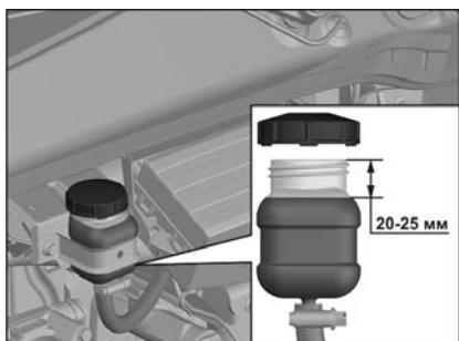
Уровень тормозной жидкости в бачке главного цилиндра сцепления должен быть ниже верхней кромки бачка на 20-25 мм.
