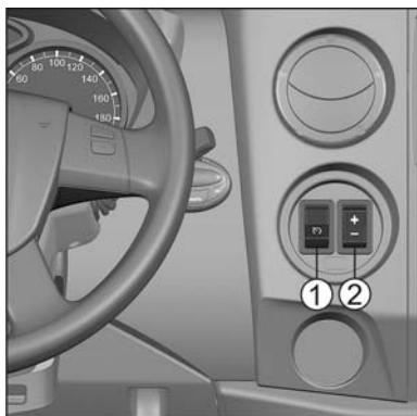
На автомобиле предусмотрен режим отбора мощности, когда часть мощности двигателя отводится на работу дополнительного оборудования.
