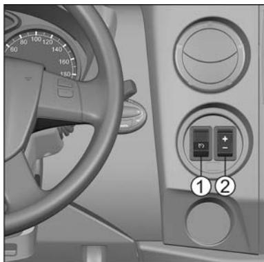
Функция «Круиз-контроль» начинает работать при скорости автомобиля более 48 км/ч. Для включения функции нажмите выключатель 1 «Круиз-контроль/Отбор мощности» и переключатель 2 «Круиз-контроль/Отбор мощности – Увеличение/Возврат», при этом на многофункциональном дисплее комбинации приборов вместо слов «TRIP» и «км» появляется символ , обозначающий движение автомобиля в режиме «Круиз-контроль».
