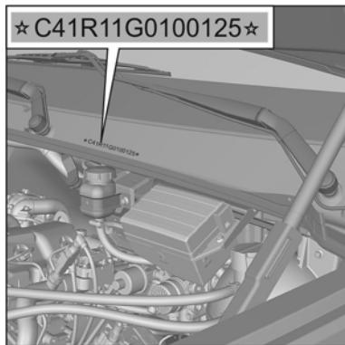
**Идентификационный номер кабины** наносится под капотом на наружной панели передка с левой стороны по ходу движения.
