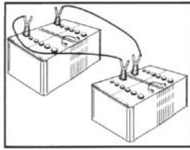
В случае полного разряда аккумуляторной батареи двигатель можно запустить при помощи другой заряженной АКБ с аналогичной спецификацией.
