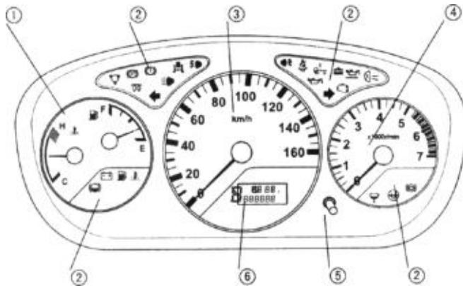
1. Указатель уровня топлива и термометр
