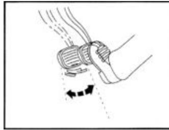
4. Ослабьте выпускной винт рабочего цилиндра и выпустите жидкость с пузырьками воздуха. Затем затяните винт.
