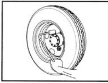
3. При помощи гаечного ключа затяните гайки крепления колеса в последовательности, показанной на рисунке. Момент затяжки гаек крепления колеса указан в подразделе «Момент затяжки основных болтов и гаек» в разделе «Техническое обслуживание автомобиля».
