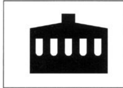
Индикатор недостаточного уровня охлаждающей жидкости (в моделях с системой отбора мощности) загорается в случае снижения уровня жидкости до минимальной отметки.
