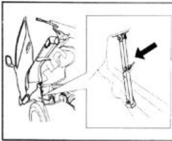
5. Чтобы опустить кабину в исходное положение, потяните стопорную рукоятку и разблокируйте опорную стойку. Опустите кабину в исходное положение, удерживая ее за вспомогательный поручень.
