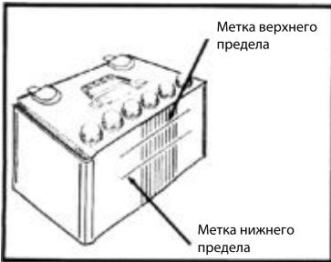
5. Проверка уровня электролита в аккумуляторной батарее.
