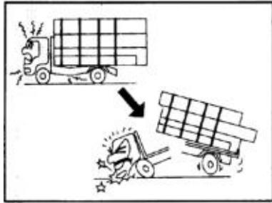
Перегрузка автомобиля приводит к неисправностям узлов и агрегатов автомобиля, выходу из строя листовых рессор и разрушению рамы.
