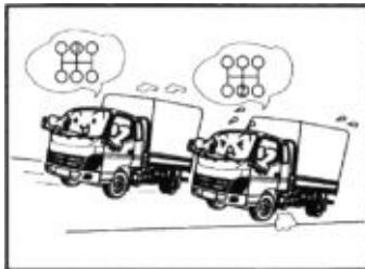
7. При движении автомобиля на подъеме пониженную передачу следует включать до того, как двигатель начнет работать с чрезмерной нагрузкой.
