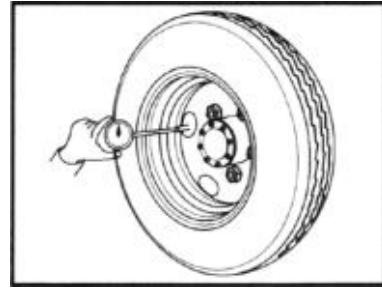
4. Поверните регулятор на 30 щелчков назад и проверьте рабочий ход рычага стояночного тормоза. Если рабочий ход рычага выходит за пределы нормы, отрегулируйте длину троса стояночного тормоза при помощи регулировочной гайки.
