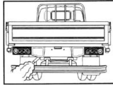
1. Проверка работы индикатора системы зарядки и индикатора недостаточного давления масла. Проверка производится при работающем двигателе.
