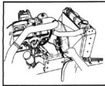
2. Проверка натяжения ремня привода вентилятора охлаждения.
