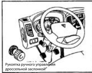
Рукоятка ручного управления дроссельной заслонкой служит для стабилизации оборотов холостого хода двигателя.
