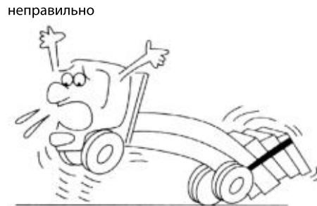
Неравномерное распределение нагрузки может затруднить движение и привести к повреждению груза и грузового кузова.
