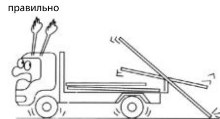
(4). Груз должен размещаться в нижней точке кузова и распределяться равномерно.
