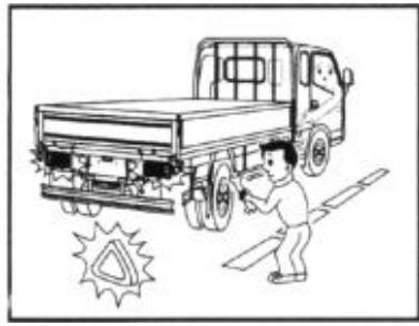
2. В обязательном порядке действуйте стояночный тормоз и включайте световую аварийную сигнализацию независимо от времени суток.
