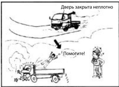
Плотно закрывайте двери во избежание самопроизвольного открывания дверей и выпадения водителя или пассажира во время движения!
