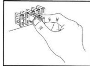
**В случае перегорания предохранителя установите причину, замените предохранитель и проведите соответствующее техническое обслуживание.**
