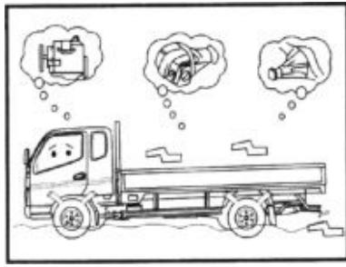
9. Будьте предельно осторожны при проезде мелководных рек и глубоких луж! Брызги воды могут попасть во впускной тракт и вызвать серьезные повреждения двигателя. После проезда водных преград проверьте картер заднего моста и коробку передач на присутствие воды. При необходимости удалите воду и залейте соответствующее трансмиссионное масло.
