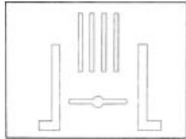
**Индикатор моторного тормоза-замедлителя** (только модели с системой отбора мощности)
