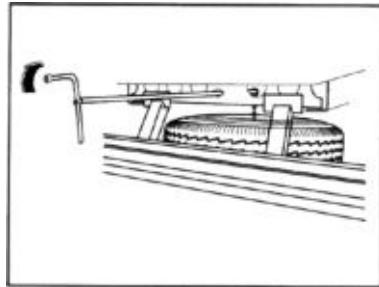
Чтобы зафиксировать запасное колесо на месте хранения, стержень с рукояткой следует поворачивать по часовой стрелке до упора.
