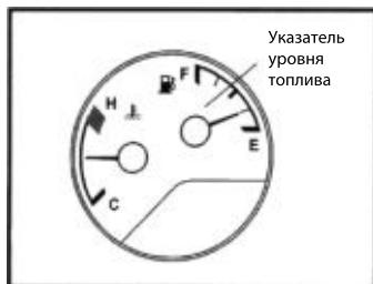
5. Проверить уровень топлива в баке (по положению стрелки указателя уровня топлива).
