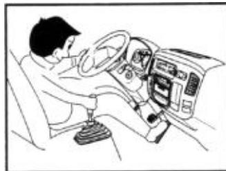
8. При движении автомобиля на спуске необходимо включать пониженную передачу для применения эффекта торможения двигателем.
