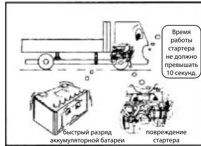
Время работы стартера не должно превышать 10 секунд. Если за это время двигатель не запустился, следующий пуск следует производить с интервалом 2 минуты. Это поможет предотвратить выход из строя стартера и сохранить заряд аккумуляторной батареи.
