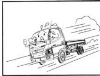
11. Не выключайте двигатель во время движения автомобиля! Это приведет к прекращению работы усилителя тормозов и, как следствие, снижению эффективности торможения. Не переводите ключ зажигания в положение «LOCK» во время движения автомобиля! Это приведет к блокировке замка рулевой колонки и, как следствие, потере контроля над автомобилем.
