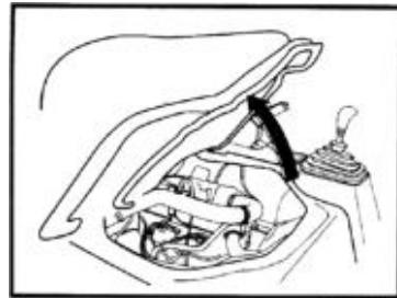
6. Осмотр агрегатов на отсутствие подтеканий топлива, масел, тормозной и охлаждающей жидкостей.
