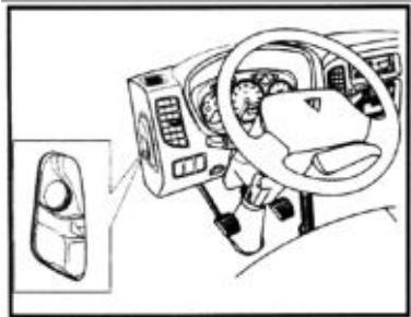
7. Проверка уровня тормозной жидкости в расширительном бачке.
