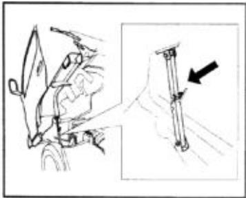
4. Дайте кабине самостоятельно опрокинуться в крайнее положение. Опорная стойка кабины должна полностью разложиться и зафиксироваться.
