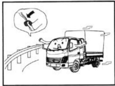
10. Будьте осторожны во время движения в условиях дождя или при проезде мелководных рек! Намокание тормозных колодок заметно снижает эффективность торможения!
