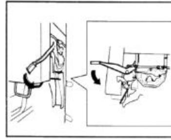
6. Полностью опустите рукоятку опрокидывания кабинны, чтобы зафиксировать кабину в исходном положении. Убедитесь в том, что кабина надежно зафиксирована при помощи основного крюка и рукоятки опрокидывания кабинны.
