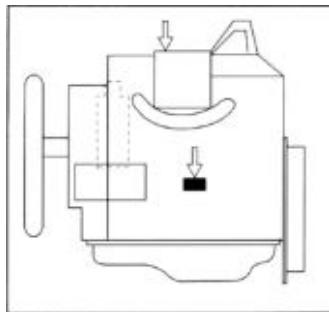
Номер двигателя выбит на левой стороне картера двигателя.
